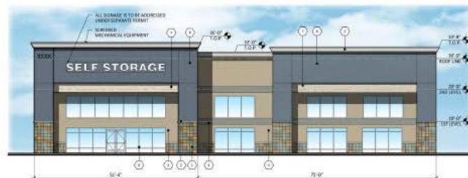
EAST ELEVATION (BUILDING A)
