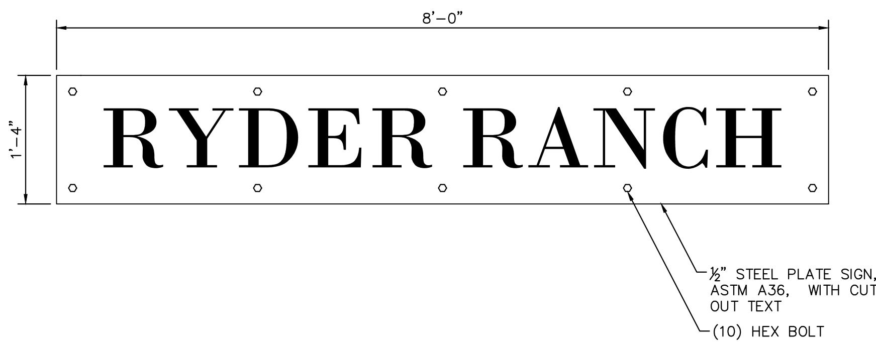
11 MILD STEEL SIGN SCALE: 1" = 1'-0"
